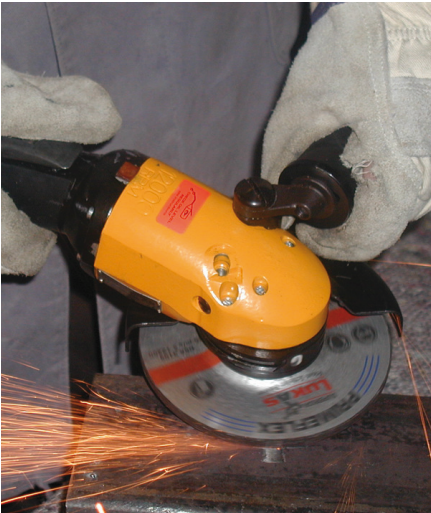
Bild 10 Vibrationsarme Schleifmaschine mit Auto-Balancing-System.
