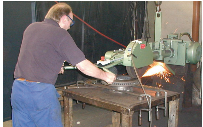
Bild 6 Bearbeitung eines Gussstücks mit Pendelschleifer.
