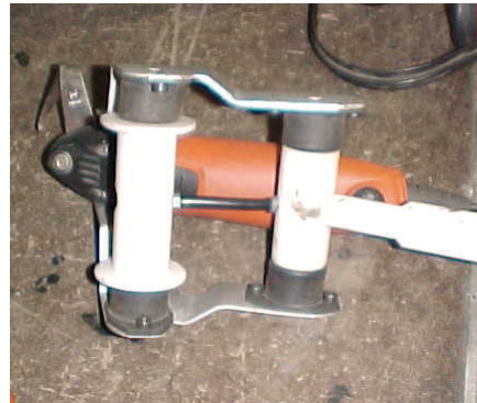
Bild 15 Prototyp eines vibrationsdämpfenden Griffs am Oszillationsmesser.
